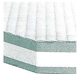
ポリスチレンフォームとインシュレーションボードを組み合わせたサンドイッチタイプの畳床
